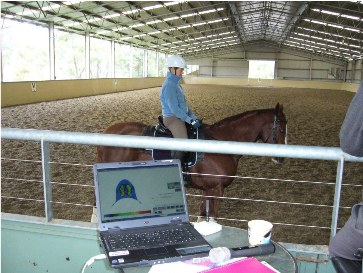
Figur 10. Ny teknologi som sadeltrykmålere gør det muligt at undersøge hvordan rytteren indvirker på hesten gennem sædet, og om rytteren sidder lige på hesten (Foto: Lesley Hawson).
